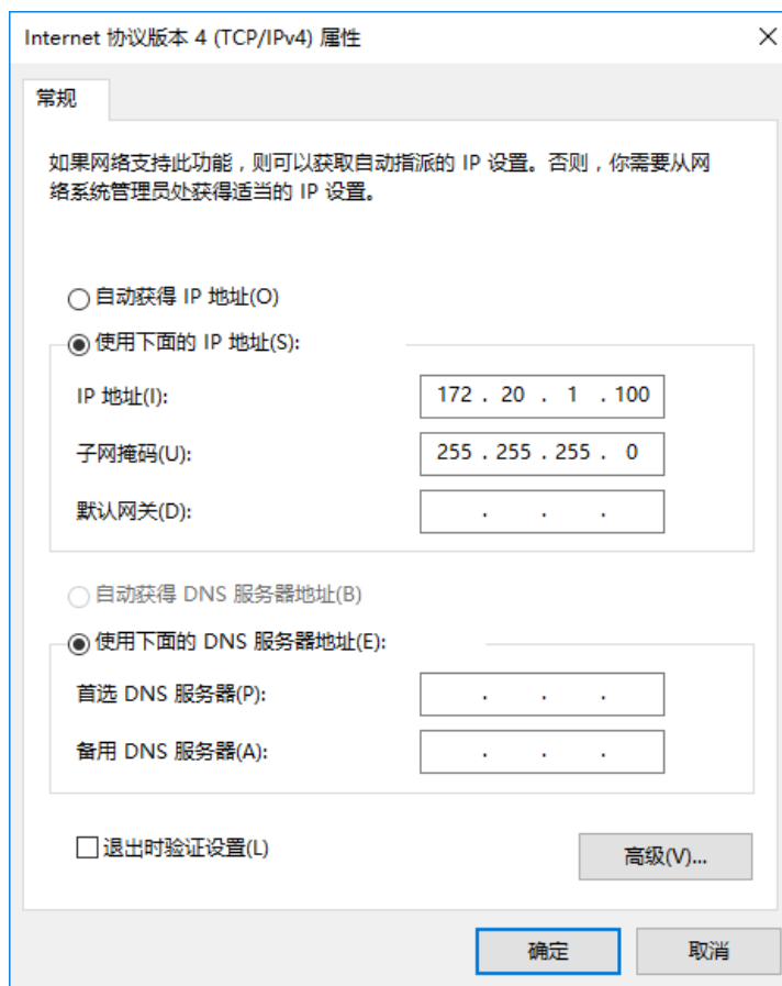
图 5-2 计算机IP地址配置示例
