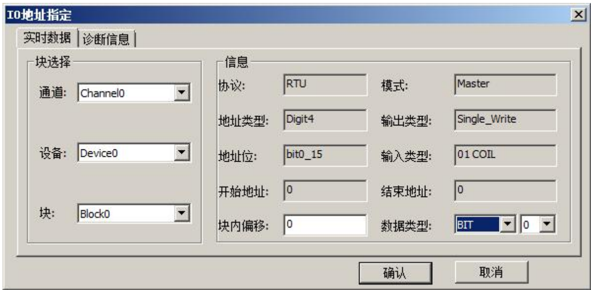
图 4-8 IO 地址设置（Modbus RTU 驱动）
