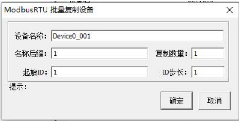
图 4-6 modbus RTU 批量复制设备界面
